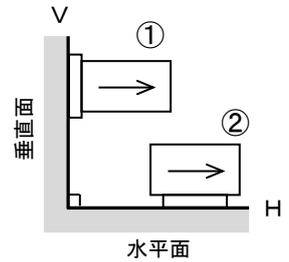
※水平方向専用型は検出方向矢印 (シール添付) が水平を向くように設置すること
